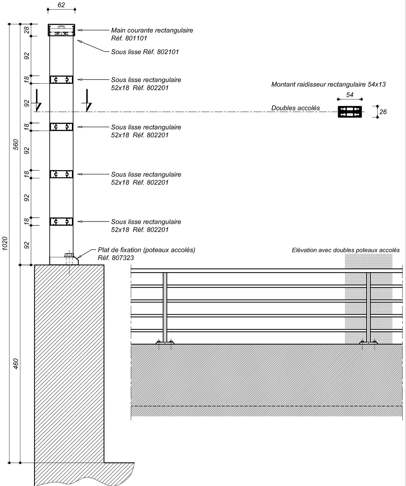
Garde-corps pour lieu privé conforme aux normes NFP01-012 et NFP01-013 - Entraxe raidisseurs 1500 maxi - Vis et chevilles de fixations sur maçonnerie non fournies.
